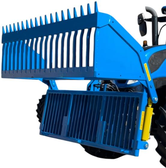
Benna mordente per attacco anteriore e posteriore al trattore. Il design particolare permette di riempire facilmente l'attrezzo senza far cadere alcuna pietra già raccolta. Sulla parte frontale sono montati denti in acciaio Hardox che sono caratterizzati da una speciale angolazione rivolta in basso. La struttura è molto affidabile poiché è costruita con acciai ad alta resistenza meccanica.
