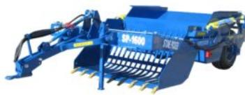
La RACCOGLI-SASSI TRAINATA SERIE SP è una macchina realizzata per un efficace lavoro di bonifica di qualsiasi tipo di terreno. La raccolta dei sassi viene eseguita mediante trascinamento. E' un attrezzo che funziona a traino ed è adatto a trattori con potenza da 40 a 120 HP in base al modello scelto
