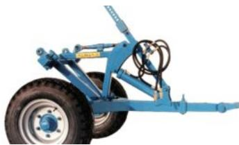
Il carrello porta attrezzi CRP8 è una macchina utilizzata per l'attacco di qualsiasi tipo di attrezzo di tipo portato, adatta per trattori a cingoli .
